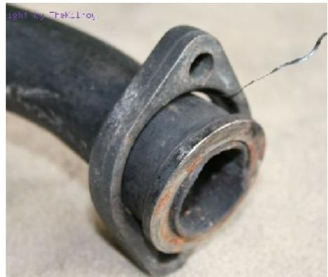
*Bild 9: Krümmerflanschdichtring*
