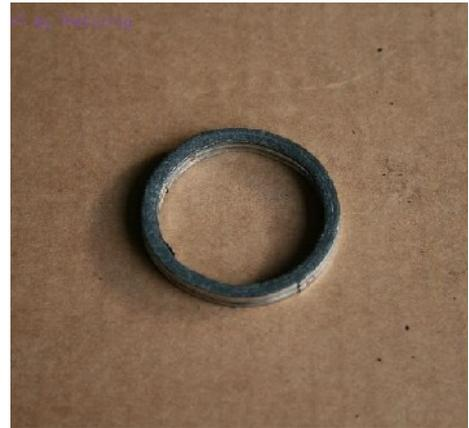
*Bild 3: Krümmerdichtung alt*
