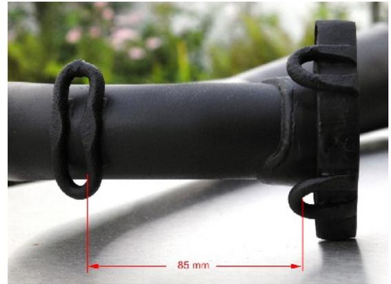
*Bild 20: Befestigung und Maße der Federn*
