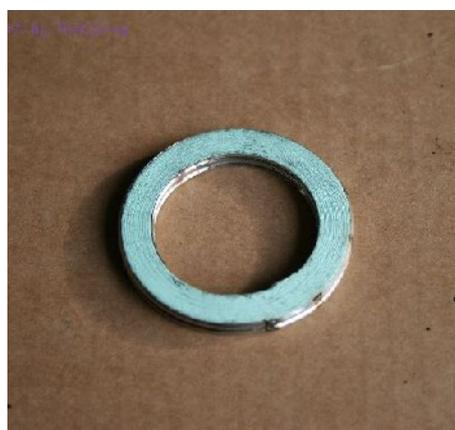
Bild 6: Krümmerdichtung neu
