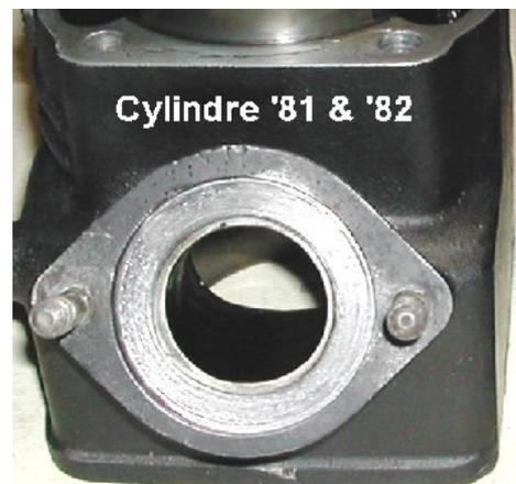
Bild 12: Zylinder mit 46 PS
