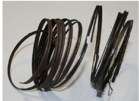
*Bild 10: Krümmerflanschdichtring, abgewickelt*
