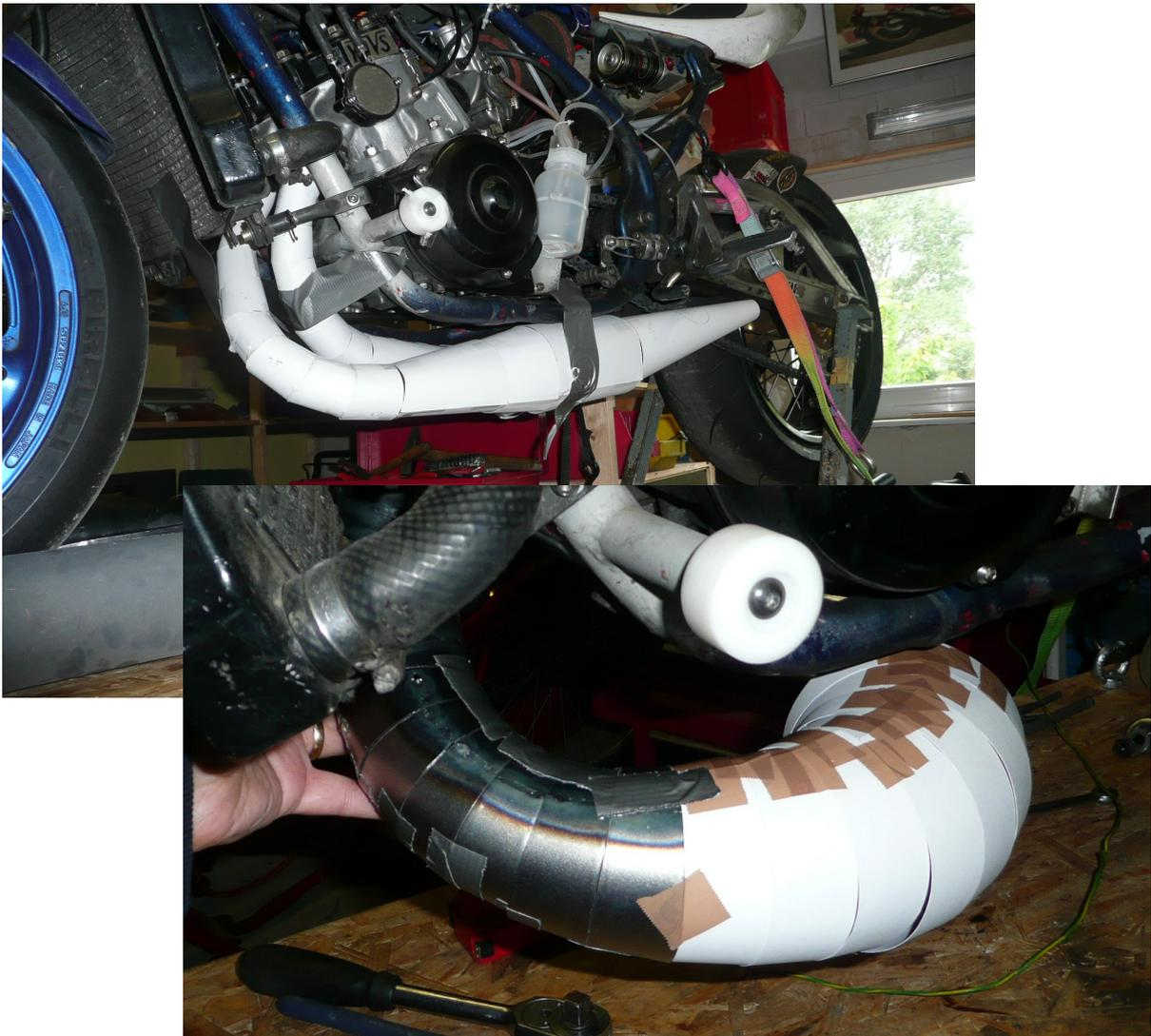
Bild 5 : Auspuff-Konzeptmodelle in Pappe bzw. Stahl/Pappe-Mix
