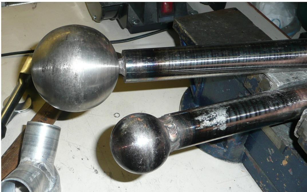
Bild 20 : „Zepter“ zum Hämmern der umlaufenden Nähte
