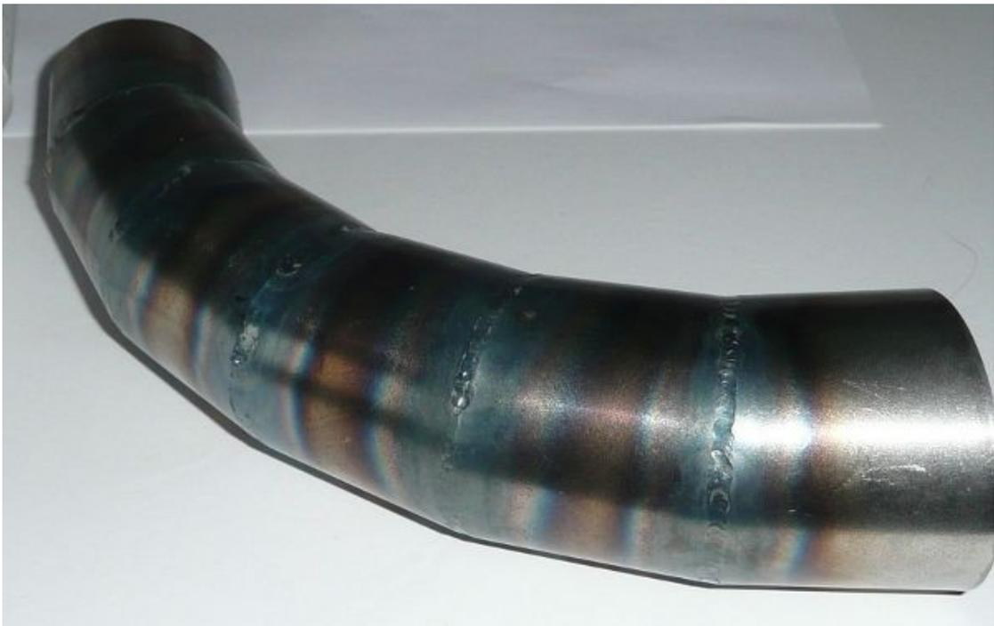
Bild 24 : Verschweißte Segmente
