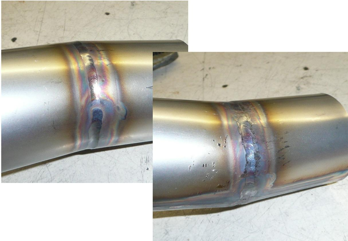
Bild 21 : Fertige Schweißnaht vor/nach dem Hämmern
