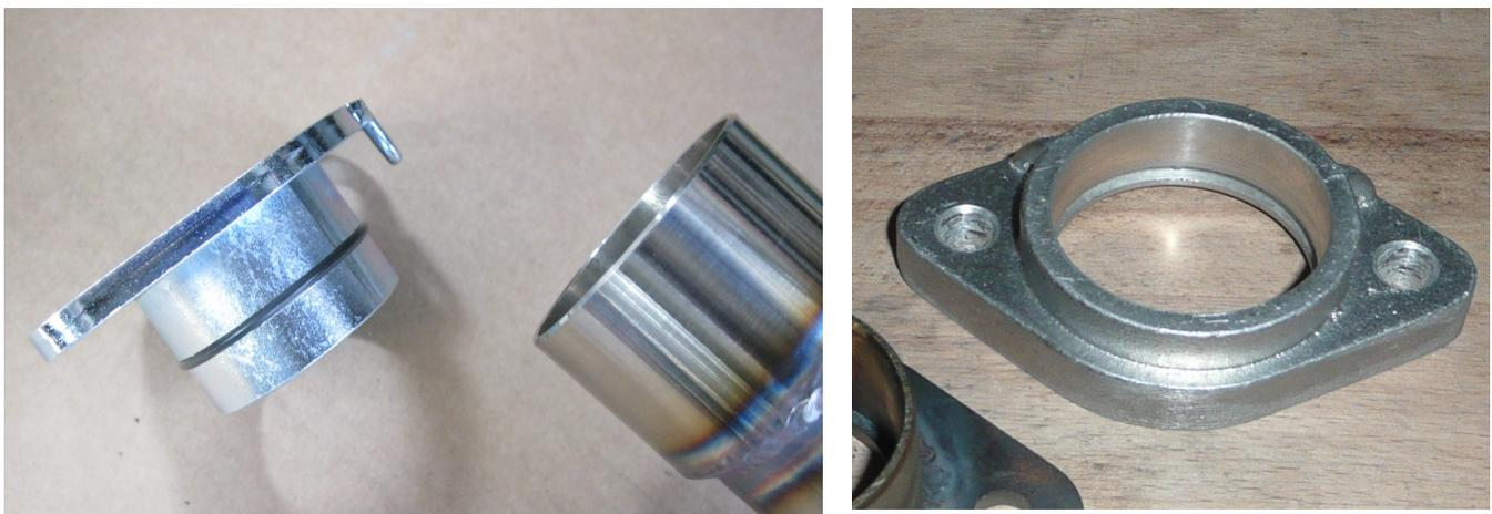
Bild 23 : Zylinderflansche mit O-Ring (Links: JL, Rechts: Jolly Moto)
