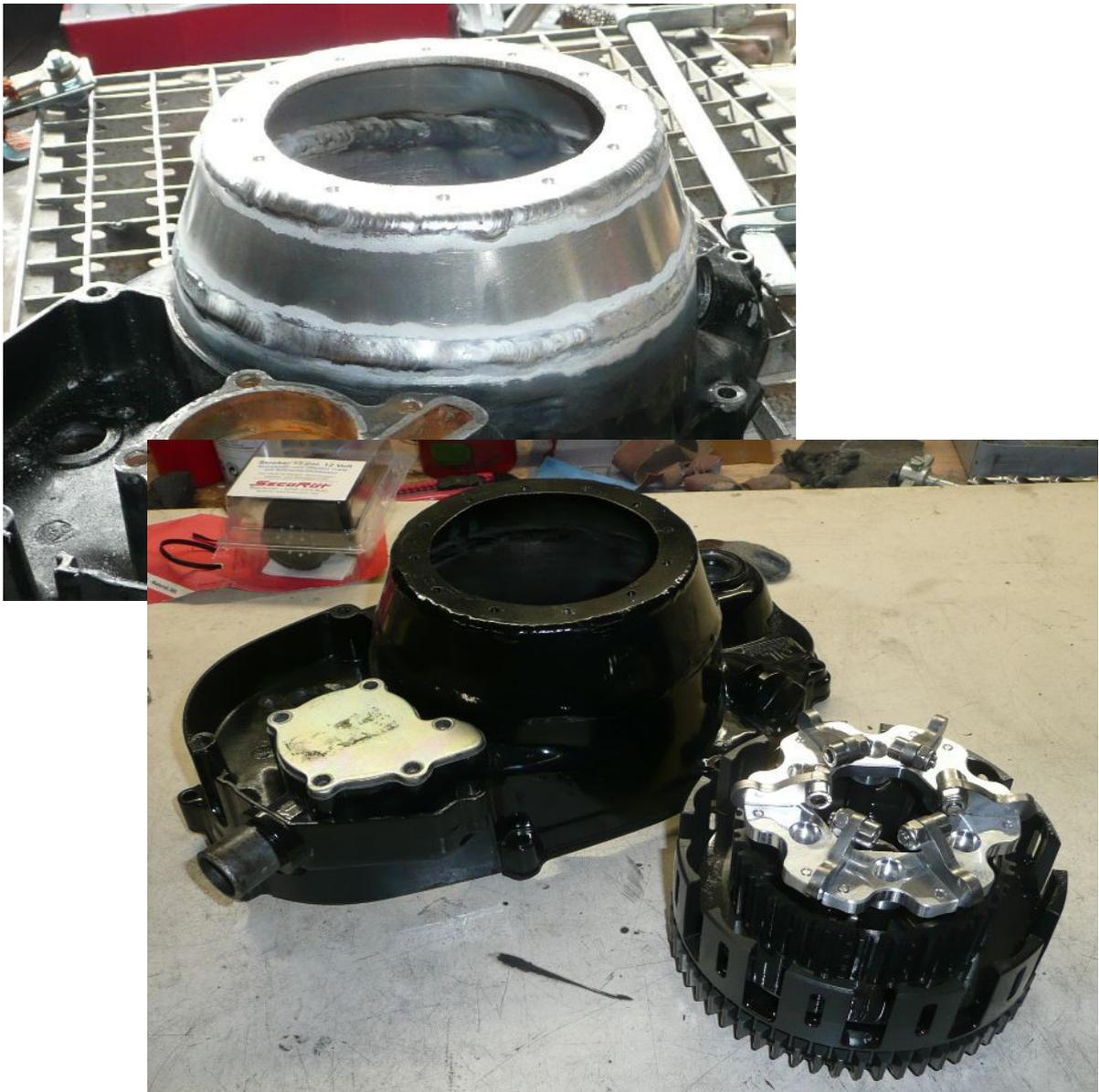
Bild 122 : Seitendeckel mit Lock-Up Clutch
