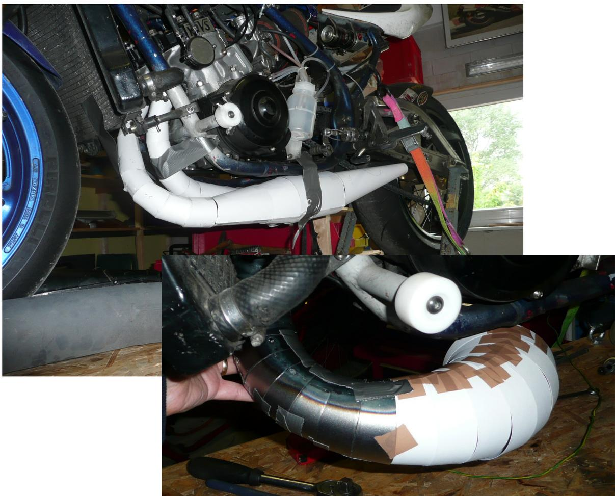
Bild 81 : Auspuff-Konzeptmodelle in Pappe bzw. Stahl/Pappe-Mix
