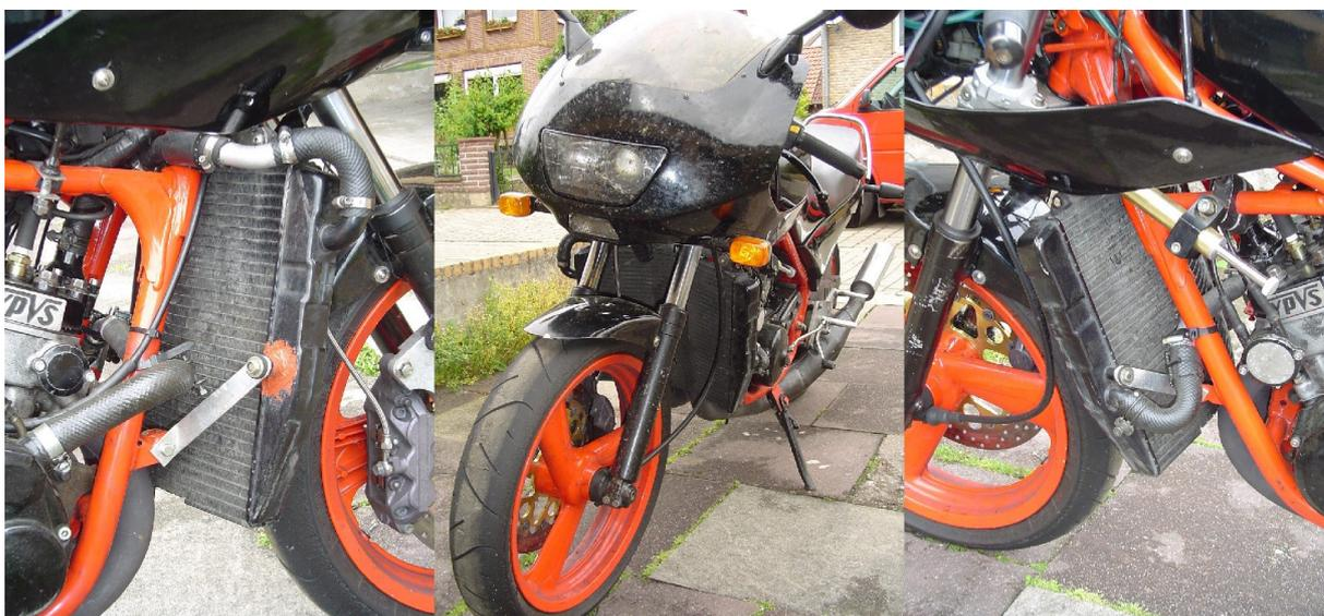
Bild 110 : RD mit GSXR 1100W-Kühler (High-End Lösung f. Extremlastungen)
