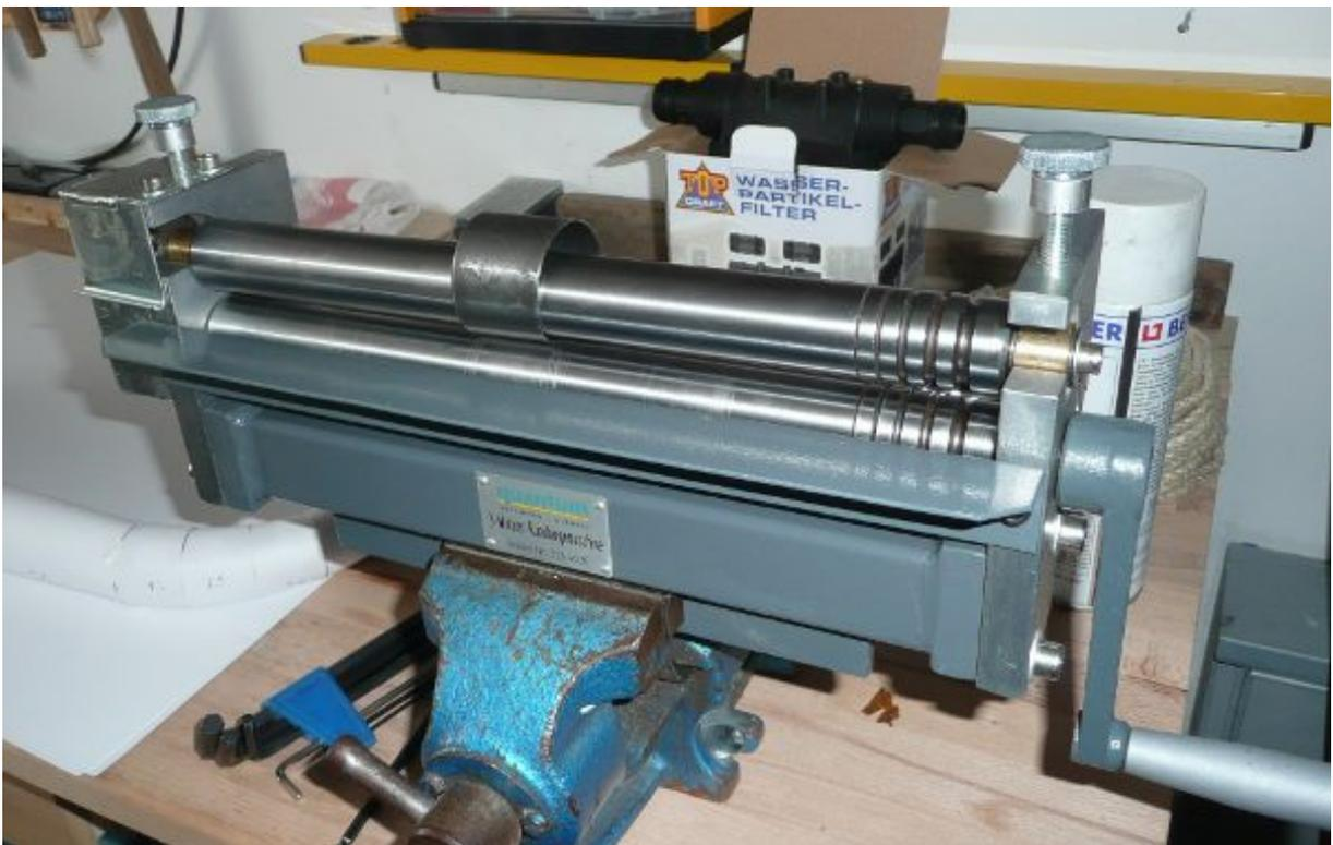
Bild 87 : Rollenbiegemaschine
