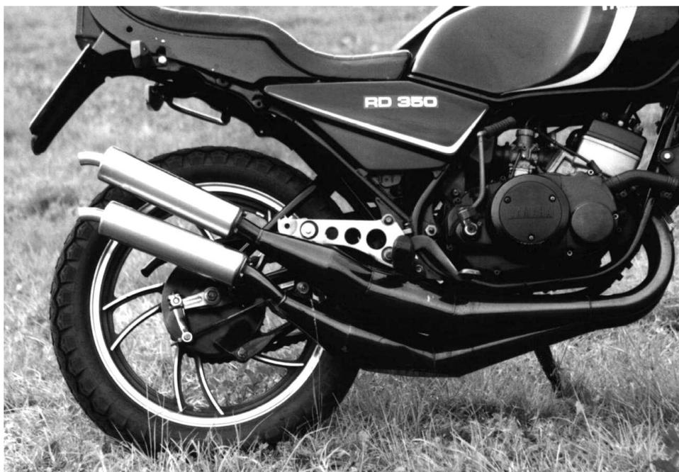
Bild 74 :Micron Hypower-Auspuff an der RD 350 LC
