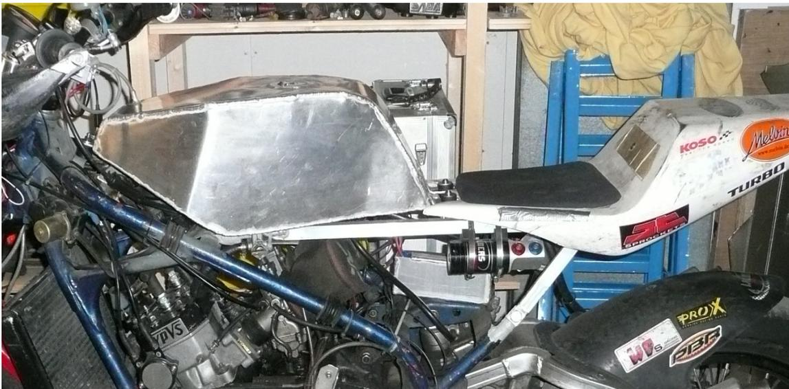
Bild 150 : Tank und Hilfsrahmen Al-Eigenbau
