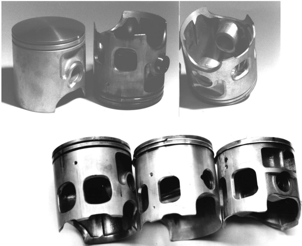
Bild 52 : Kolben nach der Bearbeitung (Oben: Prox ; Unten (von Links nach Rechts): Prox, Wiseco, TZ-350)
