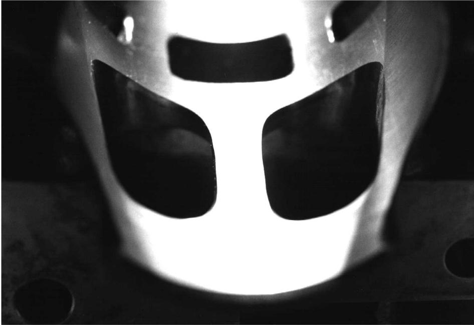
Bild 41 : Bearbeiteter Einlaßkanal einer 31K (Steg ca. 8 mm)
