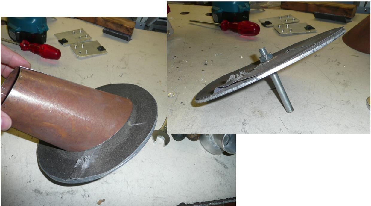
Bild 93 : Schleifplatte
