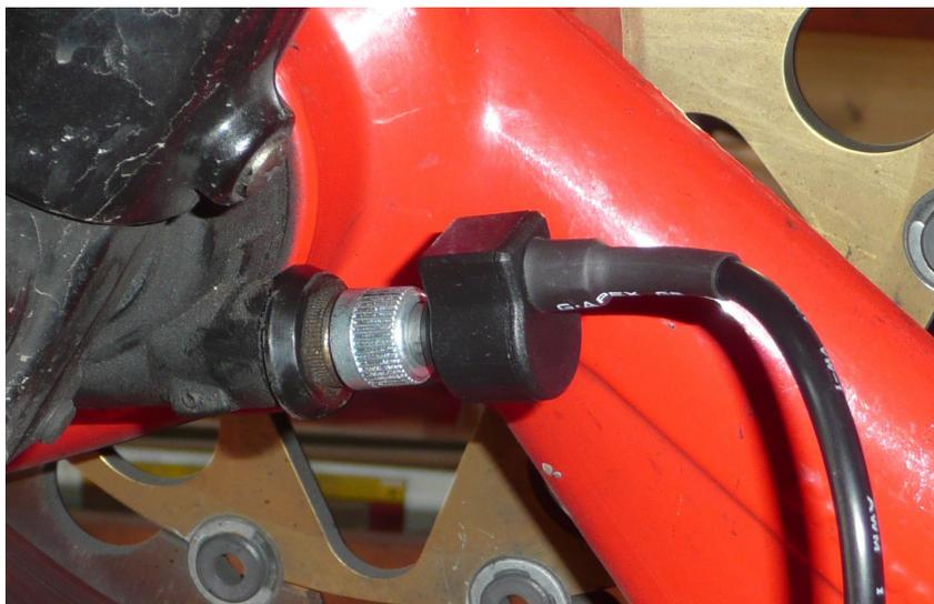
Bild 147 : Koso Signal-Adapter zum Anschrauben an die Serien-Tachoschnecke
