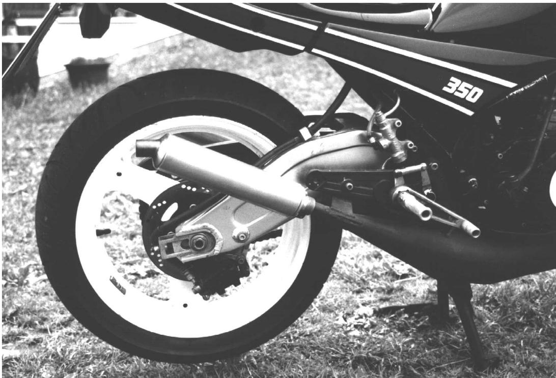
Bild 175 : RGV Bananenschwinge für RD350
