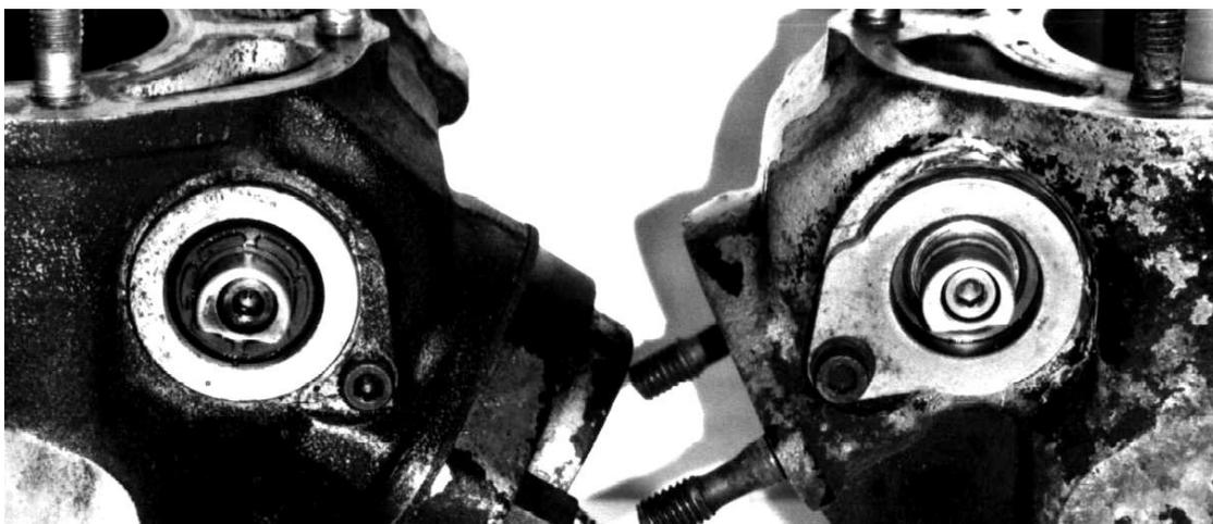
Bild 67 : Innere Lagerbuchsen der Walzen (Links: Original mit Halteblech und Adapter für Jolly-Moto-Auspuff; Rechts: Schwarz-Buchse mit Halter)
