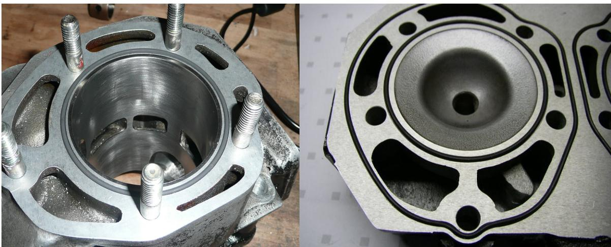
Bild 9 : O-Ring Umbau-Varianten (Links: Einzeller O-Ring im Zylinder, Rechts: 2 O-Ringe im Kopf)
