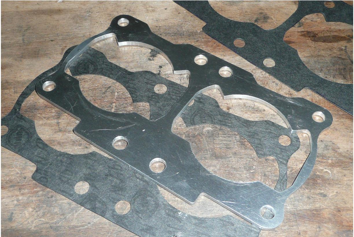
Bild 46 : Zylinderfuß-Spacer für 115 mm Pleuel
