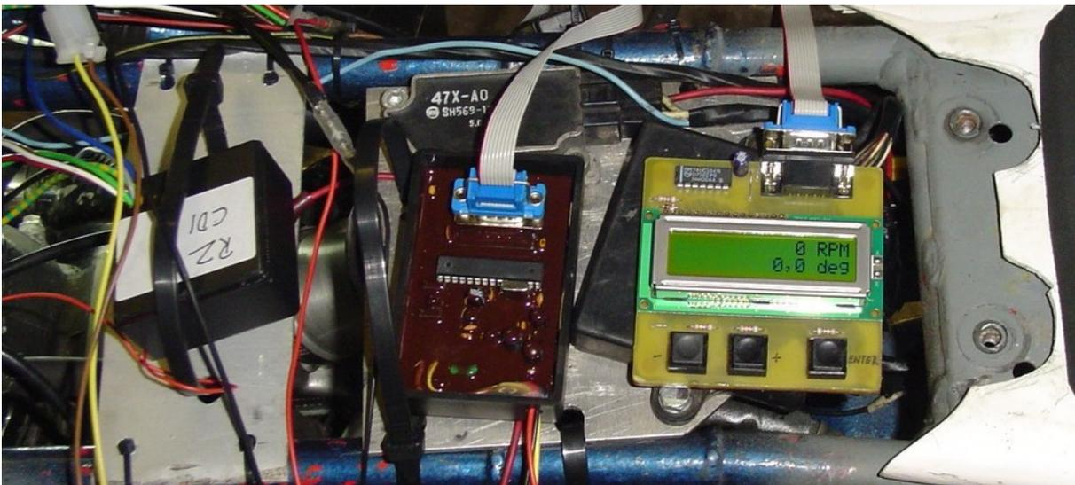
Bild 126 : CDI (links), VCDI (mitte) & Programmiergerät (rechts) (Prototypen aus 2005 von www.zeeltronic.com)
