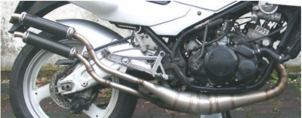
Bild 73 : JL (SoniX) GP-Anlage in Edelstahl mit Carbondämpfer
