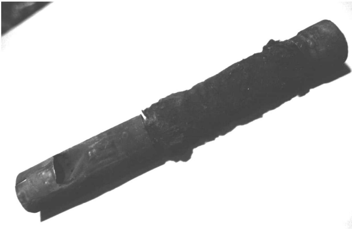
Bild 75 : Schalldämpfer 31K (mit Glaswolle umwickelt)
