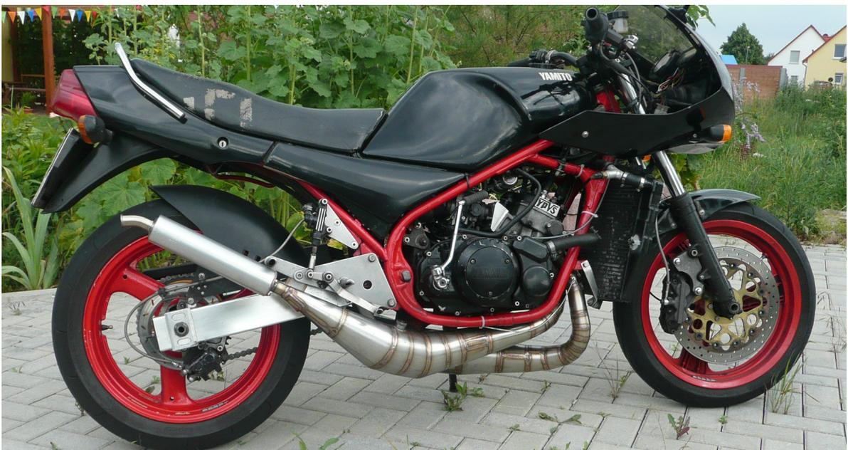
Bild 103 : Eigenbau mit gekreuztem Layout in Edelstahl
