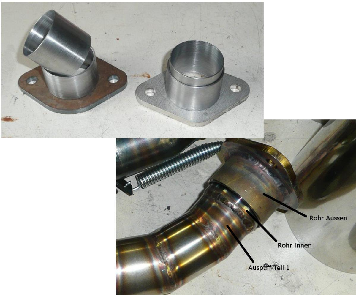
Bild 99 : Zylinderflansche (Eigenbau)
