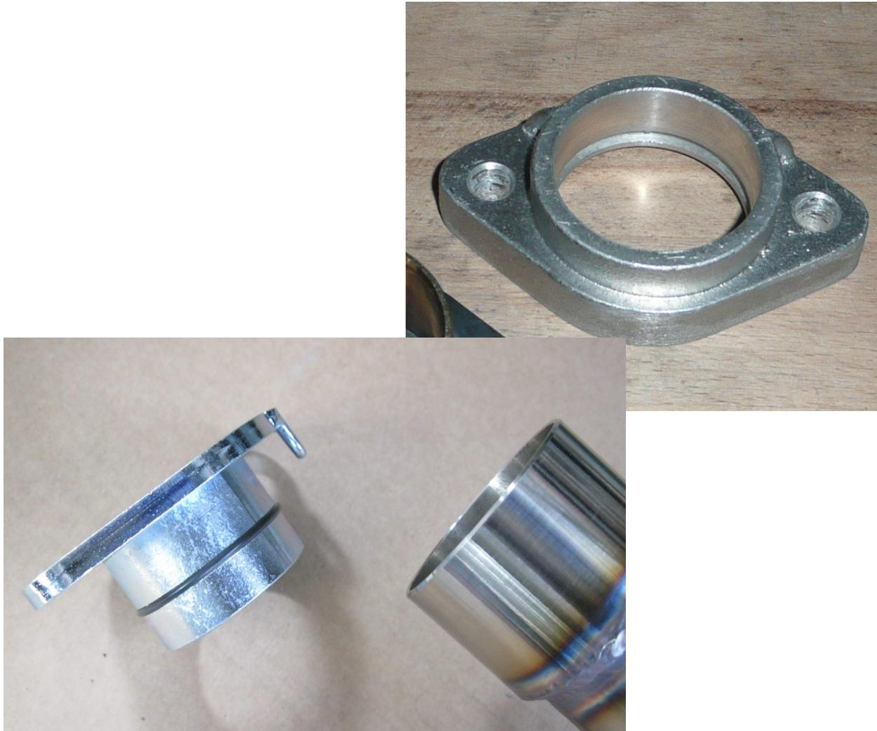
Bild 100 : Zylinderflansche mit O-Ring (Oben: Jolly-Moto, Unten: JL)
