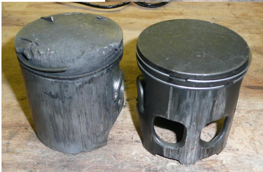
Bild 55 : Kolben nach Standzeitende (Auslass-Seite geschmolzen, Ringe gebrochen, Klemmer, usw. ...)
