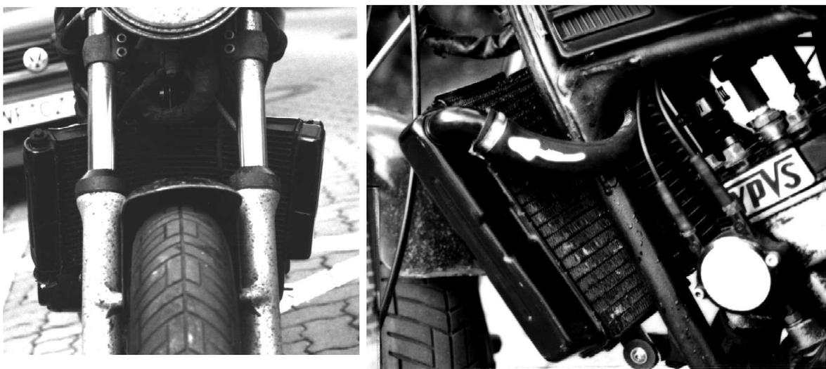
Bild 109 : RD mit RGV-Kühler
