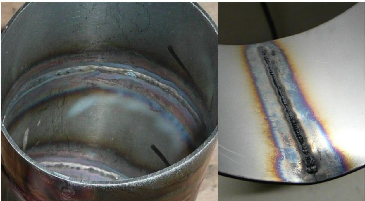
Bild 91 : Innenseite in VA mit Formiergas (links) und „Blumenkohl-Bildung“ ohne Formiergas (rechts)
