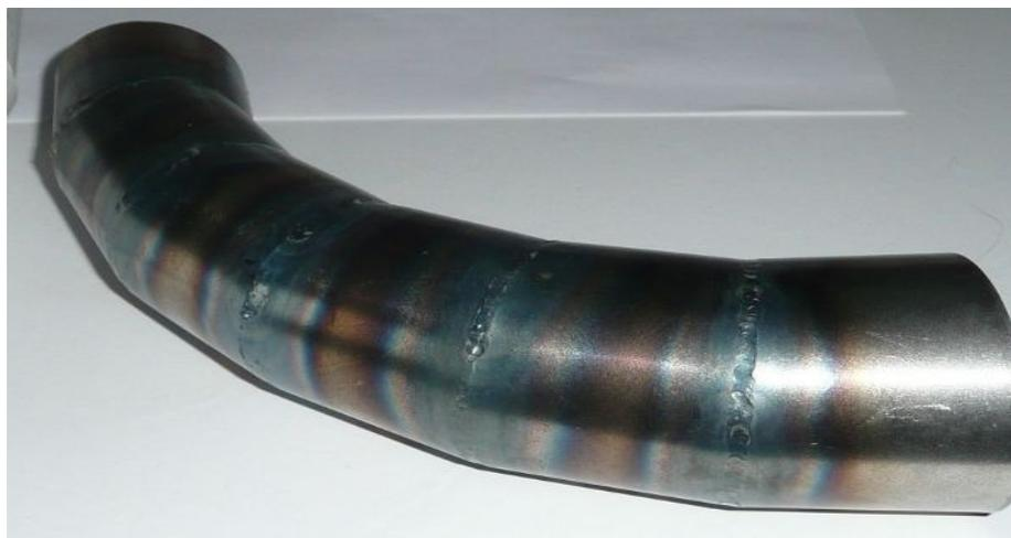
Bild 98 : Verschweißte Segmente
