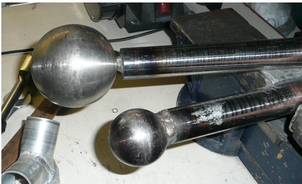
Bild 96 : „Zepter“ zum Hämmern der umlaufenden Nähte
