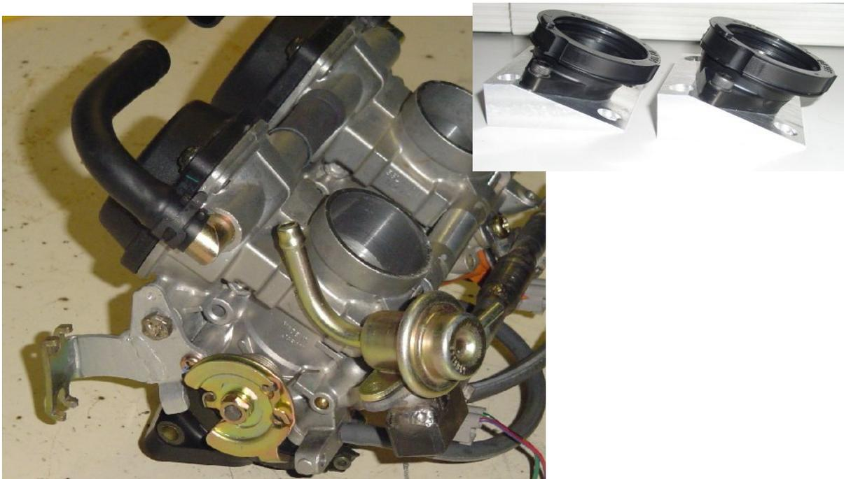
Bild 29 : R6 Ansaugstutzen, Einspritzkörper und Druckregelventil f. meine RD350 modifiziert.
