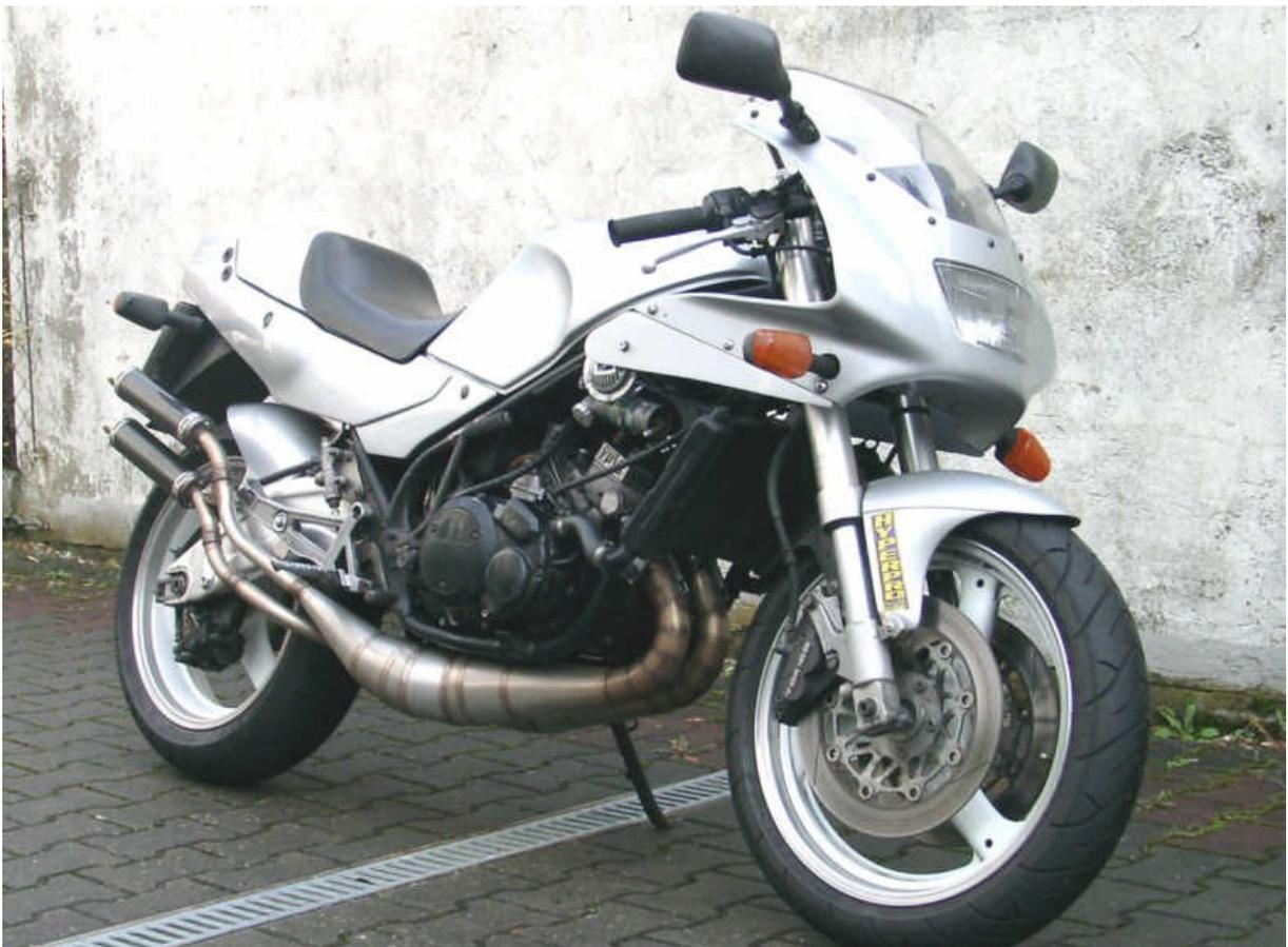
Bild 176 : 1WW mit RGV-Kit: Gabel, Schwinge und Halbschale
