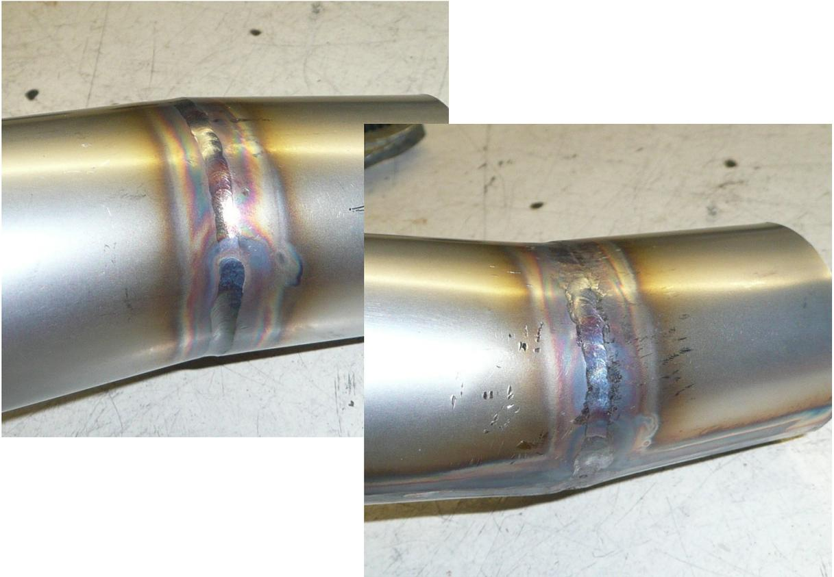
Bild 97 : Fertige Schweißnaht vor/nach dem Hämmern
