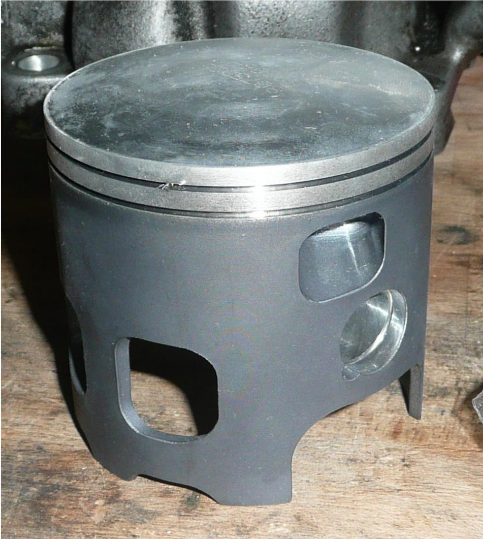
Bild 51 : Woessner Schmiede-Kolben
