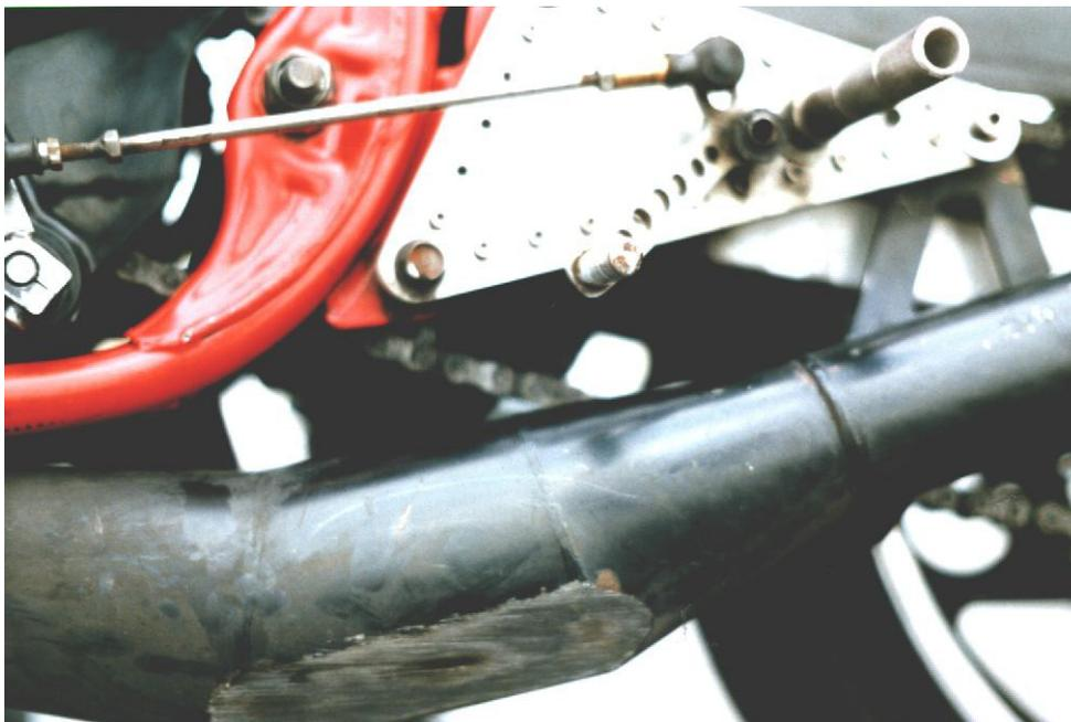
Bild 10 : Eigenbau Fußrastenanlage und Dörr-Auspuff mit sehr mangelhafter Schräglagenfreiheit (Juni 1988)
