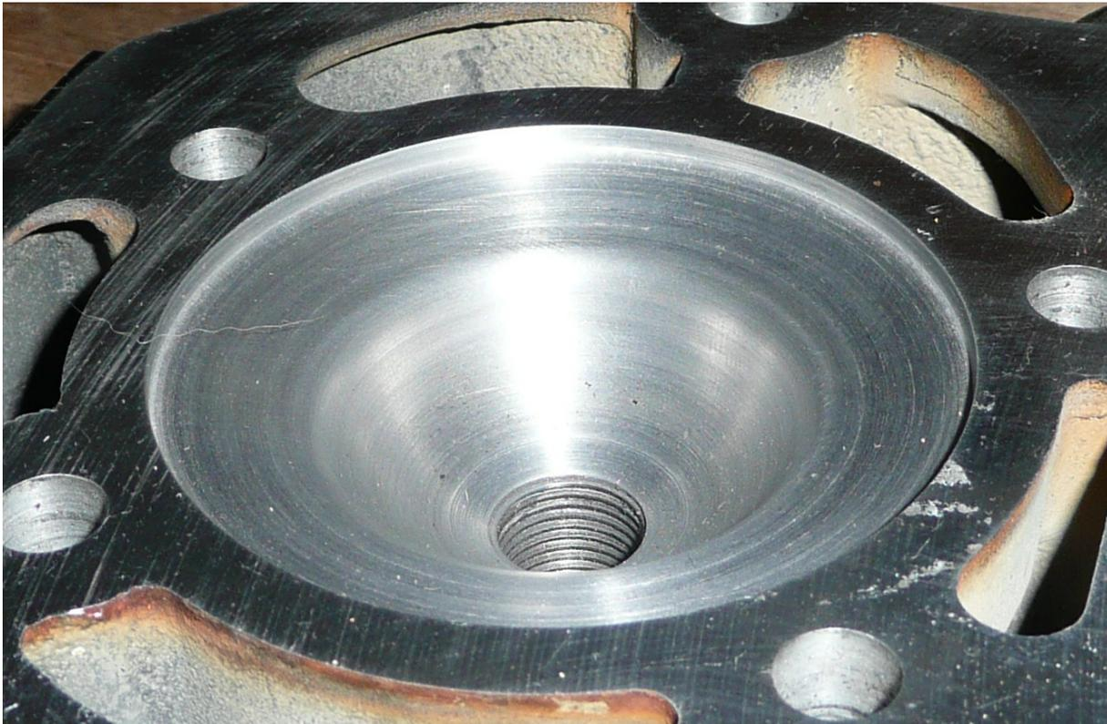
Bild 47 : Kopf-Bearbeitung für 4 mm Welle
