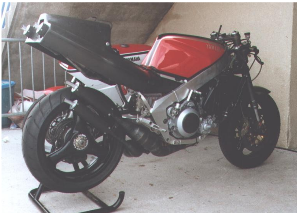
Bild 154: Gerome Buscail's RD500 mit Sambiasi Rahmen und Einarmschwinge
