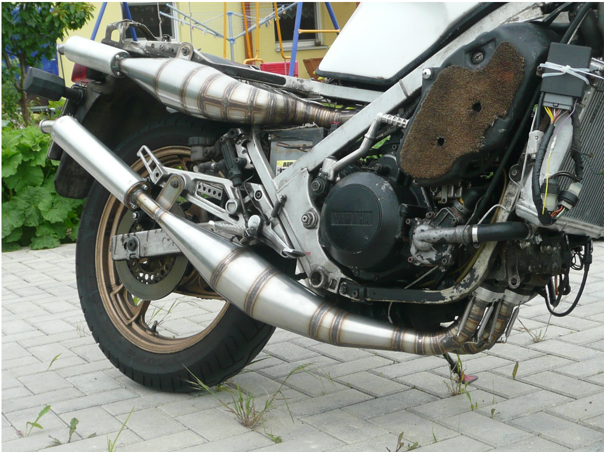
Bild 104 : Eigenbau-Auspuff in VA nach Wayne Wright (2013)
