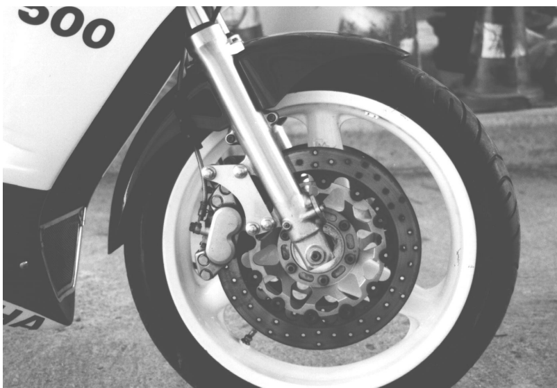
Bild 152: Und noch mal FZR1000 : Vorderrad mit Guß-Scheiben und Adapter an RD500 Gabel
