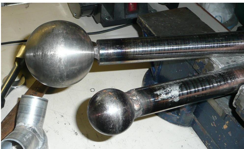
Bild 99 : „Zepter“ zum Hämmern der umlaufenden Nähte
