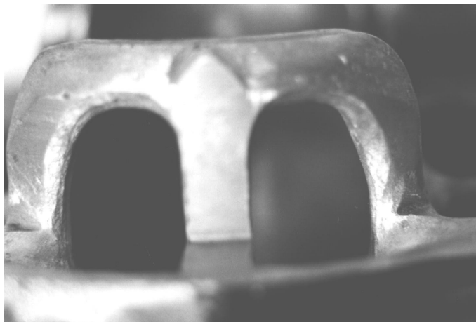
Bild 55: Oben links: Laufbuchse aus dem Kurbelgehäuse gesehen; Rest:: Bearbeitung der Laufbuchse (hintere Zylinder / Einlaßbereich)
