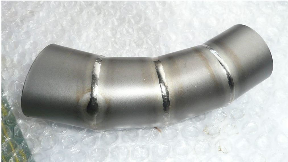
Bild 95 : Header in Titan
