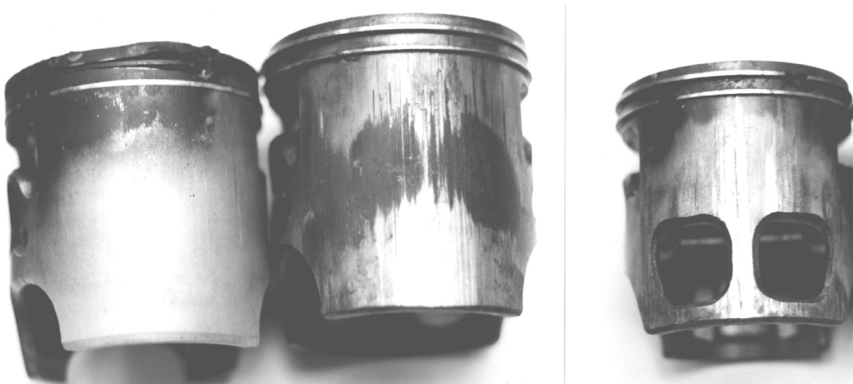
Bild 63: Kolbenschäden (Links: Ring vorderer Kolben gebrochen; Rest: Klemmer hinterer Kolben, Aus- und Einlaßseite)
