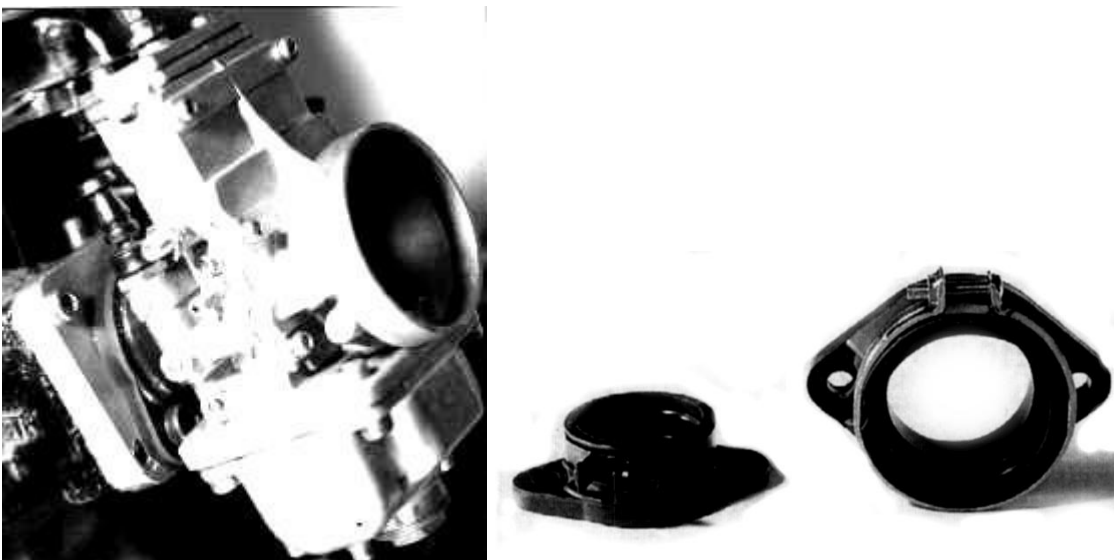
Bild 25: Mikuni-Ansaugstutzen und Eigenbau-Lösung für RD350
