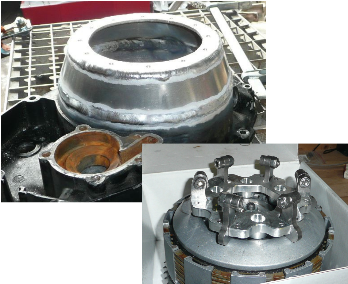
Bild 141 : Seitendeckel mit Lock-Up Clutch
