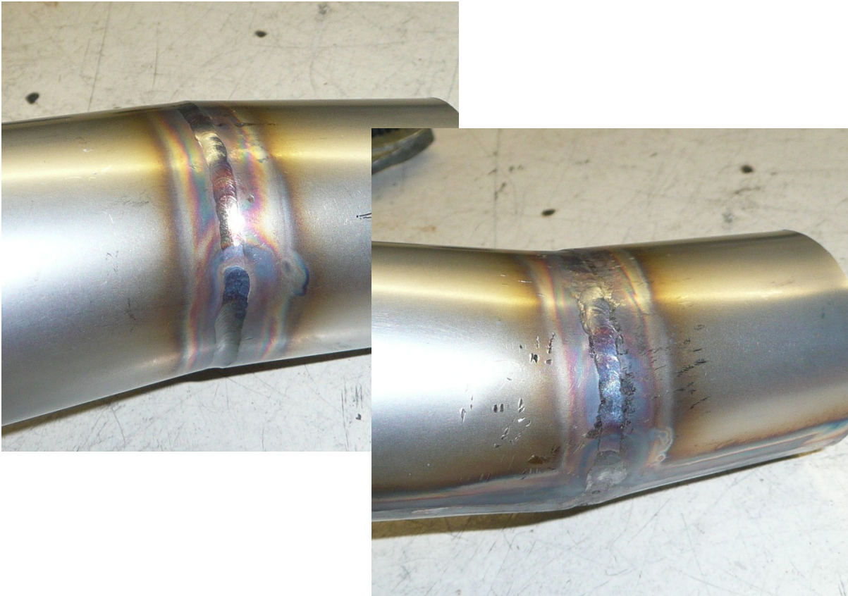
Bild 100 : Fertige Schweißnaht vor/nach dem Hämmern
