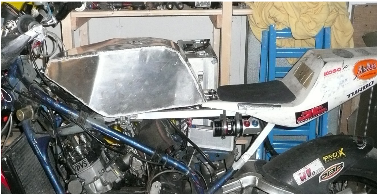
Bild 144 : Tank und Hilfsrahmen Al-Eigenbau (RD350)
