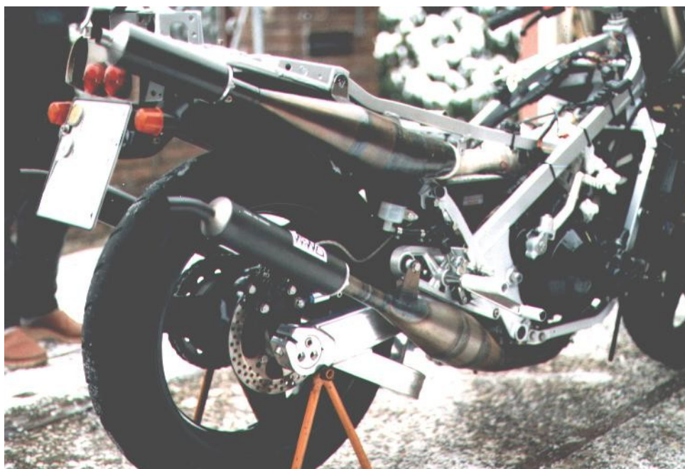
Bild 77: Jolly-Moto-Auspuff f. RD500 (Carbondämpfer sind gegen Aufpreis lieferbar)
