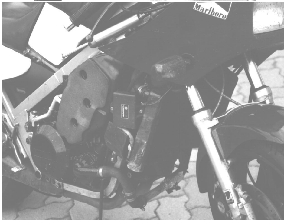
Bild 139: Oben: RD500 mit geändertem GSXR 750 W Kühler
