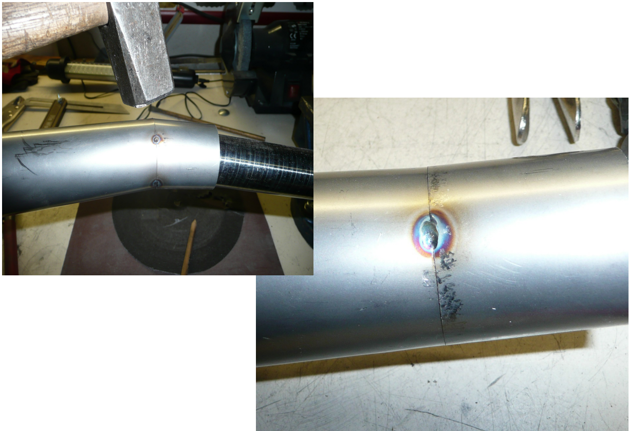
Bild 98 : Hämmern nach dem Heften und Ergebnis
