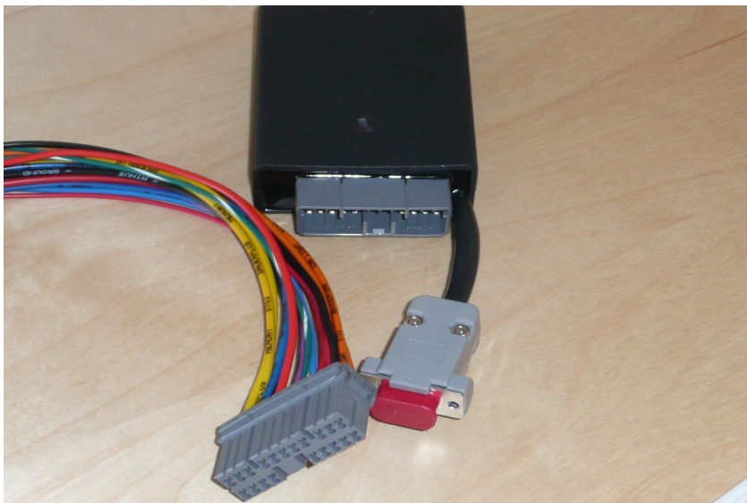
Bild 114 : Ignitech DC-CDI P2 mit Kabel
