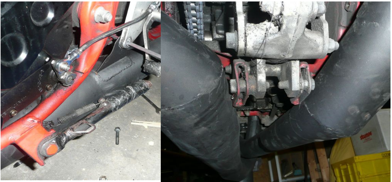
Bild 86 : Problemzonen Umlenkung &amp; Seitenständer
