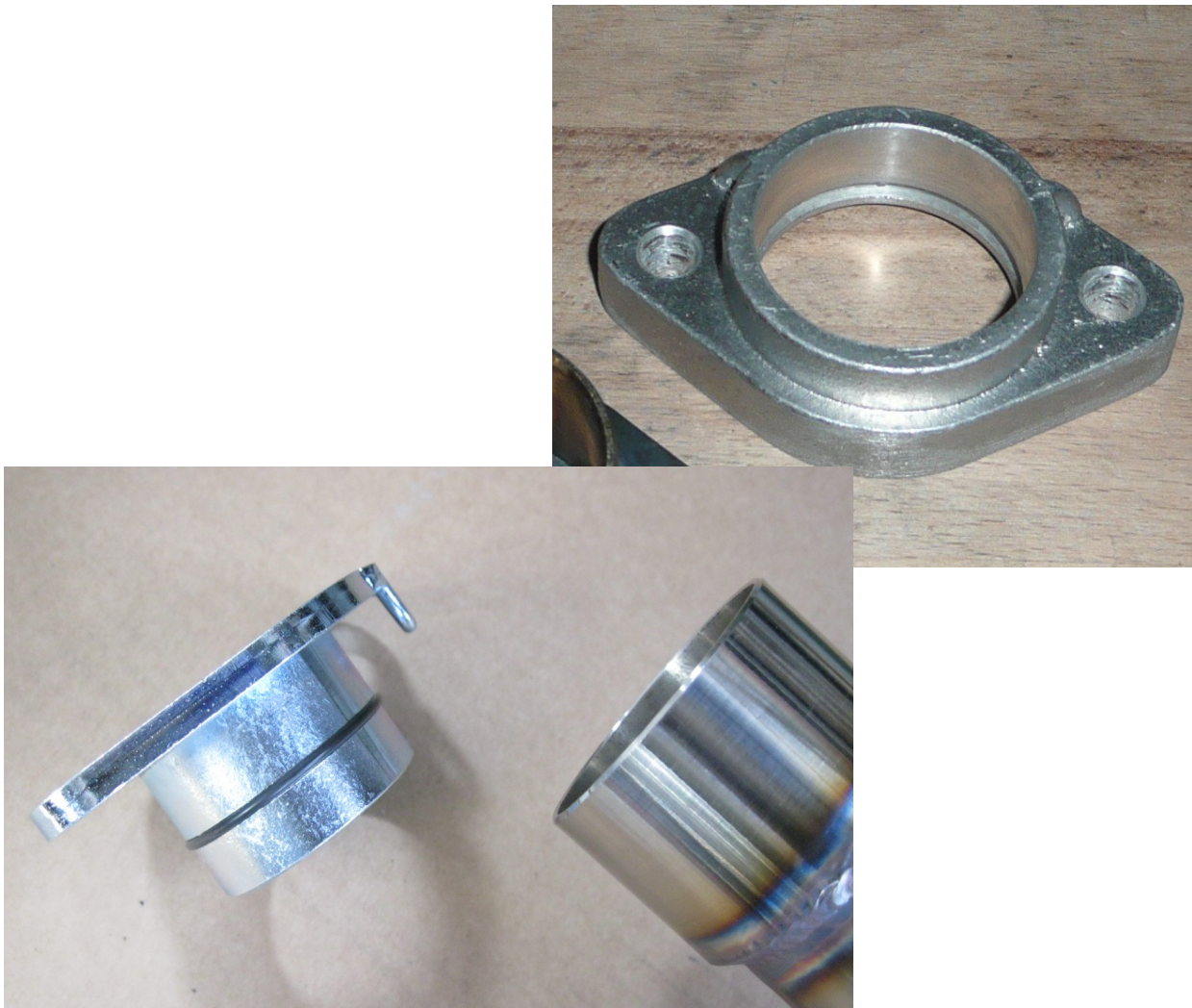
Bild 103 : Zylinderflansche mit O-Ring (Oben: Jolly-Moto, Unten: JL)
