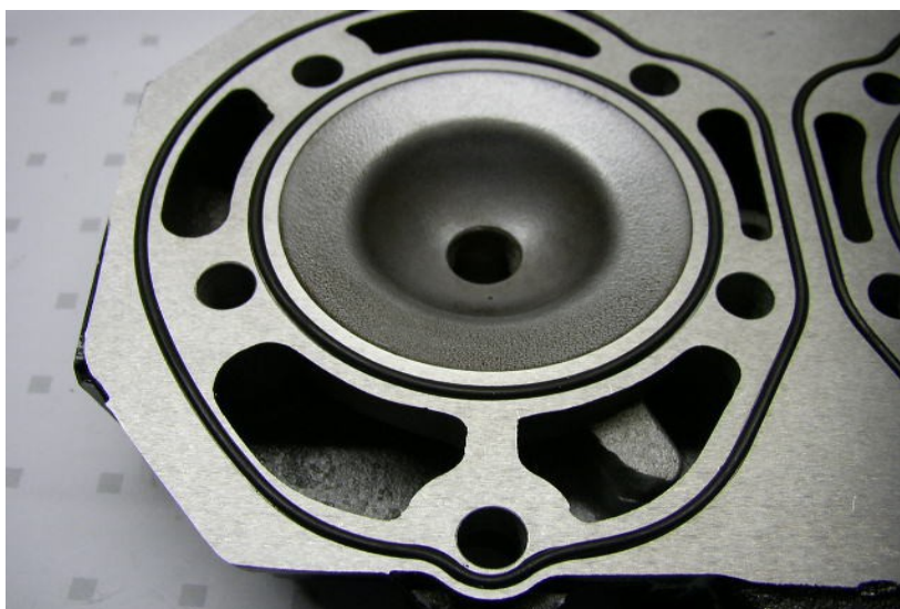
Bild 72 : O-Ring Umbau am Zylinderkopf (RD350)
