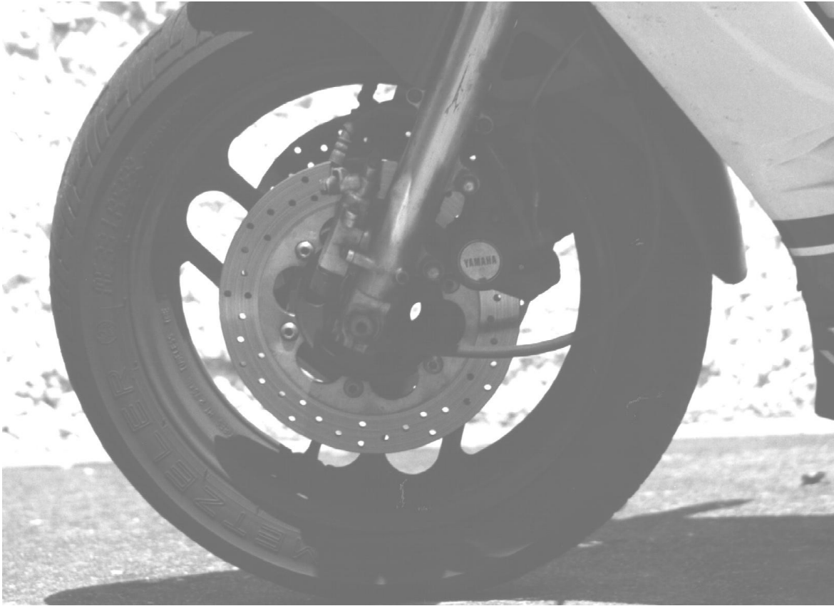
Bild 147: Spiegler-Bremsscheiben für RD 500 mit TÜV [3]
